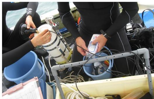
写真-3.7 多項目水質測定器による測定
