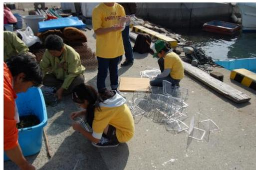
写真-4.4 金網を板を使って直角に折り曲げ
