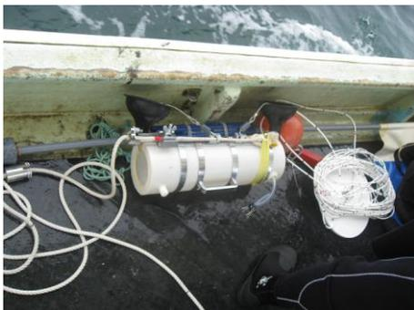
写真-3.6 バンドーン型採水器
