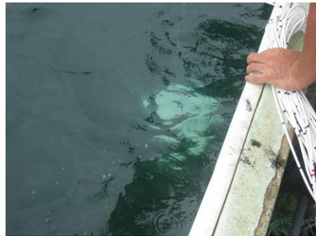
写真-3.5 透明度および水深の測定
