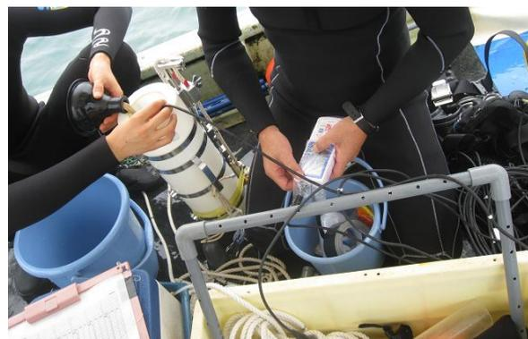
写真-2.7 多項目水質測定器による測定
